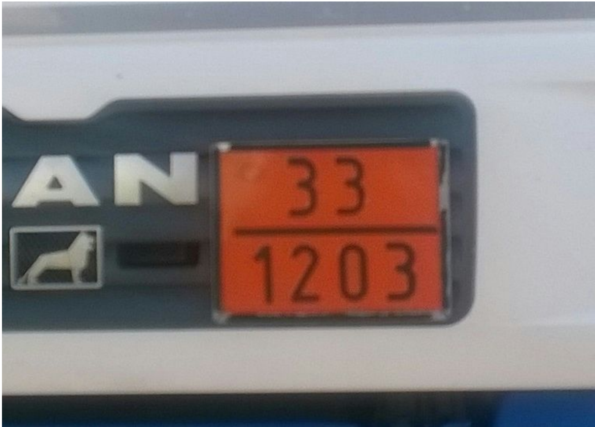
Tablice barwy pomarańczowej na pojeździe przewożącym UN 1203 paliwo silnikowe lub benzynę w cysternie
