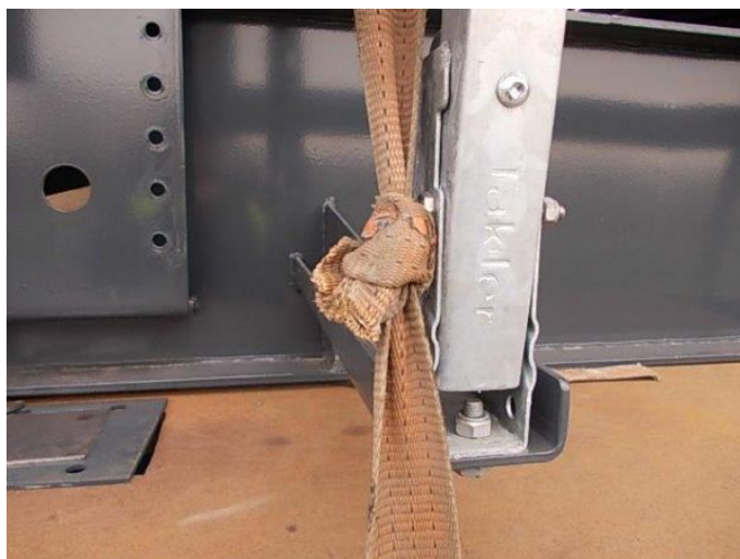
Uszkodzony pas zabezpieczający, źródło: WITD Opole.
